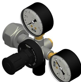
ATTACCO BOMBOLA SECONDO NORMA UNI 11144 - DIN 477 MAX PRESSIONE DI INGRESSO= 120 BAR MAX REGOLAZIONE RIDUTTORE= 5,5 BAR ±0,5 INIZIO SFIATO VALVOLA DI SICUREZZA= 7 BAR +0,5 MAX SOVRAPRESSIONE= +8%
